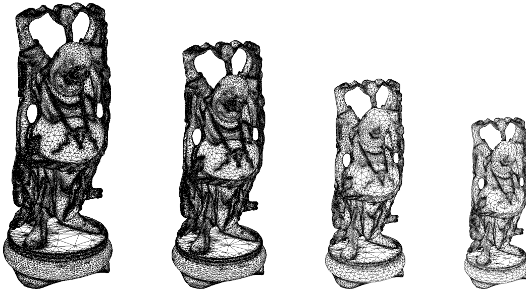
FIG. 2 – Application de la simplification géométrique à la visualisation graphique (la complexité du modèle dépend de sa position relative dans la scène).
