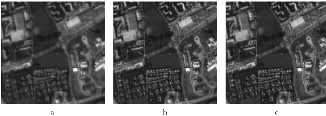
a) Image floue et bruitée de Nîmes, simulation SPOT 5, ©CNES, b) image déconvoluée par seuillage optimal dans une base de paquet d'ondelettes complexes, c) résultat de l'algorithme hybride après estimation des paramètres adaptatifs sur l'image b)
